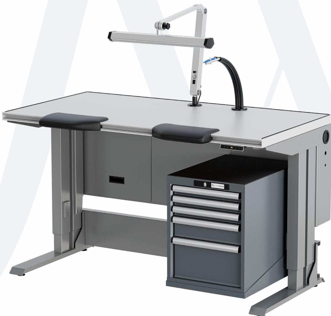
Établi d'horloger à piétement en "T" avec réglage électrique de la hauteur et commande à mémorisation de position, accoudoirs coulissants sur rail, lampe LED avec réglage de l'intensité, col de cygne double vacuum et air comprimé, dos technique, armoire à tiroirs sur socle et caches pour piétement électrique.
